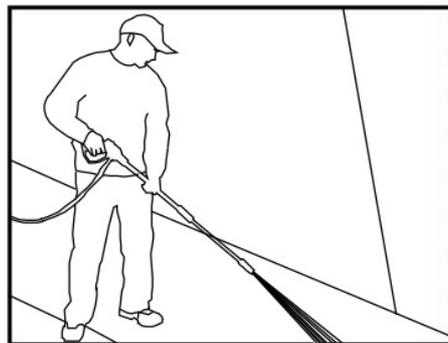
Распыление воды на поверхность при этом угол обеспечивает наиболее выгодное сила удара в сочетании с эффективной удалением мусора с поверхности.
